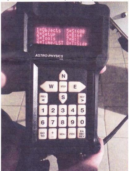
En cas de déplacement incontrôlé du télescope (avec un GOTO ou via l'ordinateur), appuyer sur STOP. Le télescope s'arrête immédiatement sans perdre sa position dans le
